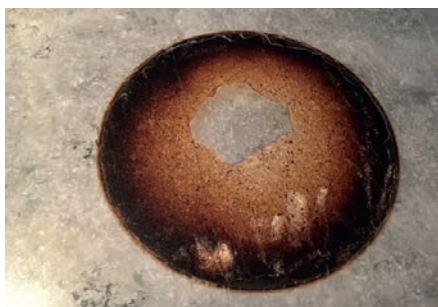
Sengschaden durch heisse Pfanne auf Küchenabdeckung
